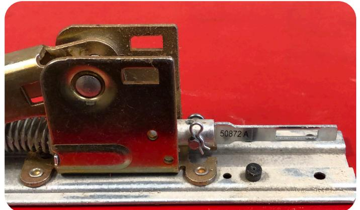
8. GRAB YOUR MOTOR AND INSERT ATTACHING BRACKET AT SLIGHT ANGLE THROUGH THE WINDOW ON THE DOGGING TAIL.
